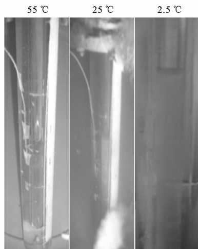
图4 混合制冷剂与矿物油处于临界互溶点时的情况
